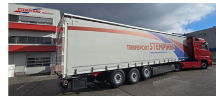
Kögel Light Plus – sodobna, lahka prikolica z dviznimi osmi in prilagodljivo nadgradnjo za različne vrste prevozov.
