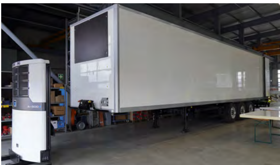
Polpriklopnik iz novega materiala naj bi bil dobrih 700 kilogramov lažji od njihovega trenutnega - to je kar 9-odstotni prihranek pri masi.
