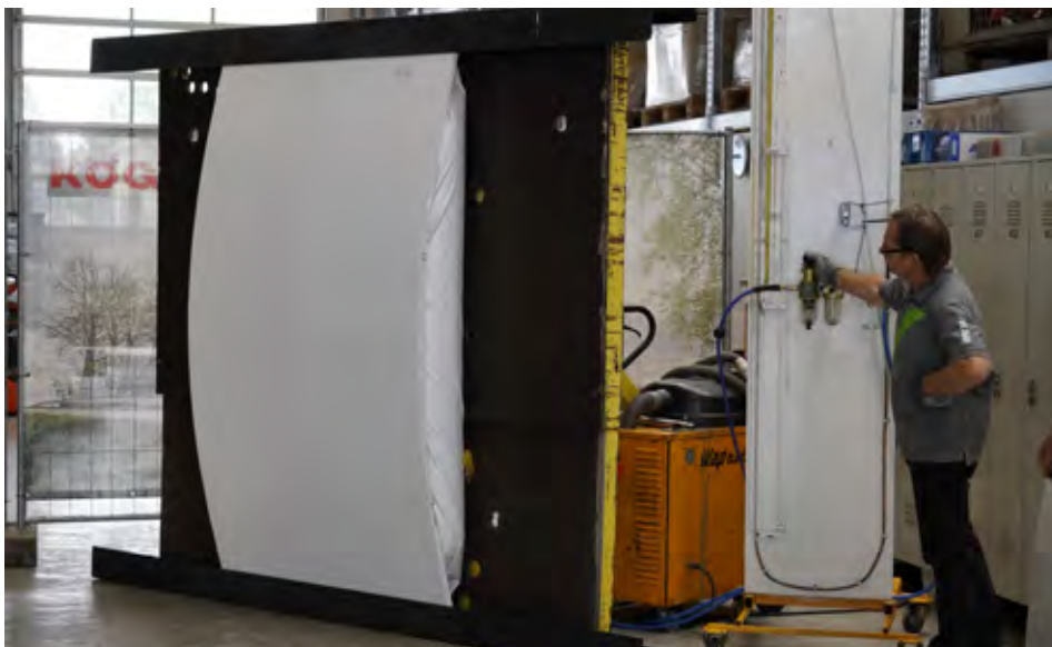
Panel LiteShell se deformira elastično, zato so deformacije lahko veliko obsežnejše in brez nevarnosti za trajne poškodbe, saj se panel po razbremenitvi povrne v prvotni položaj.
