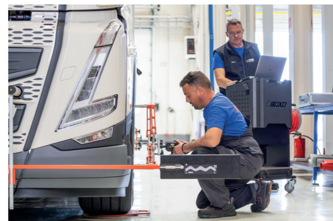
Pravilna nastavitve podvozja pri tovornih vozilih in tudi pri prikolicah je nujno potrebna za zagotavljanje varnosti, ob tem pa manjša izrabo pnevmatik in nižja poraba goriva.
